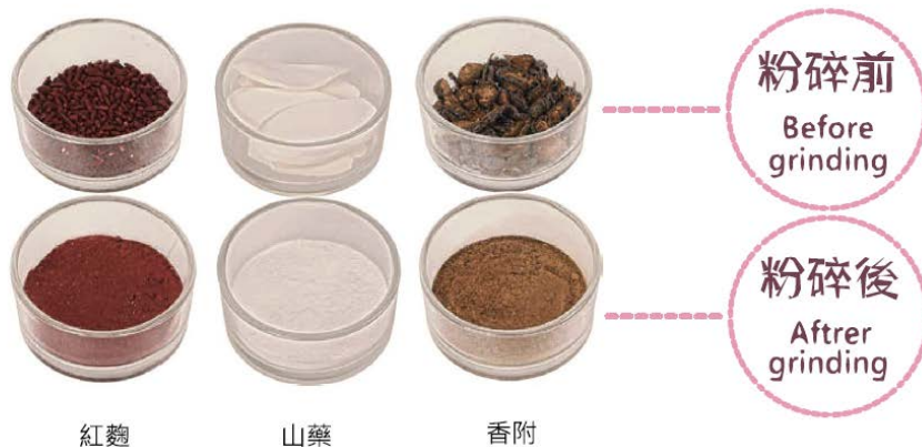
SM-3C冷却粉碎机的粉碎效果图
